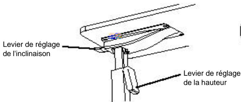
Figure 2 : Inclinaison de la table de lit à levier de réglage de l'inclinaison
