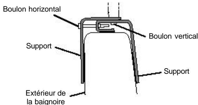
Figure 4 : Installation de la barre d'appui à une poignée et de la barre d'appui à trois poignées
