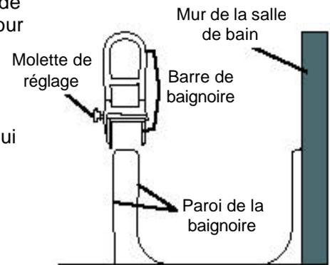
Figure 1 : Installation de la barre d'appui pour baignoire avec molette de réglage
